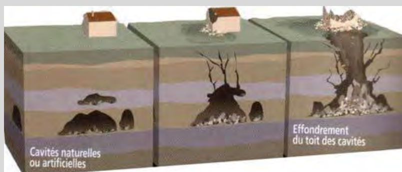
Figure 118 : Phénomène d'effondrement de cavités souterraines
